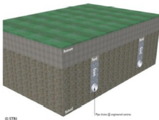
Fig. 2: Profilo di una falda drenata
